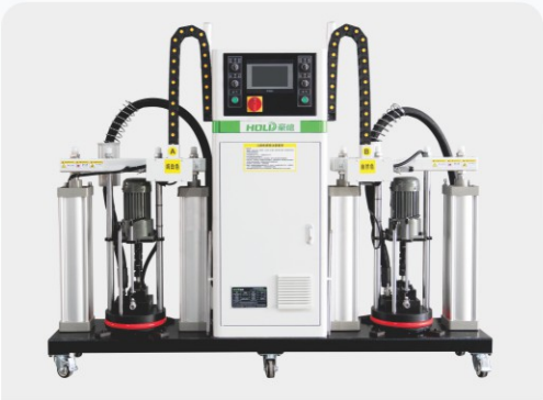
一字型双拼PUR自动注胶机(Y) I-shape PUR melter(Y)
